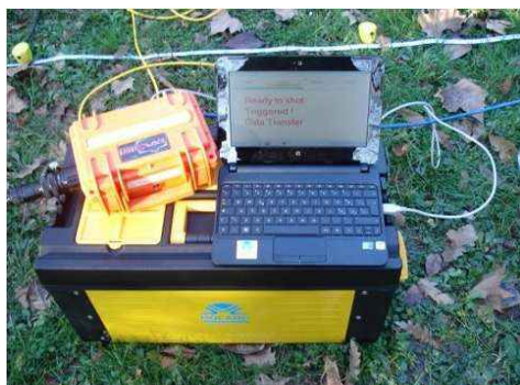
Fig. I. Vista del sismografo DBS 280 e del NetbookPC portatile collegato tramite cavo USB per l'acquisizione del segnale. Il sistema si basa sulla acquisizione e conversione dei dati con tecnologia MAX, connessione e alimentazione USB.
