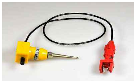
Fig. II. Particolare del geofono elettromagnetico a bobina mobile, con frequenza di 4,5 Hz, utilizzato per le prospezioni sismiche a rifrazione.
