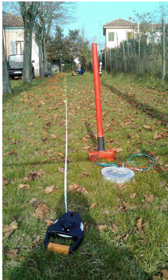
Fig. XI. Vista dello stendimento MASW.
